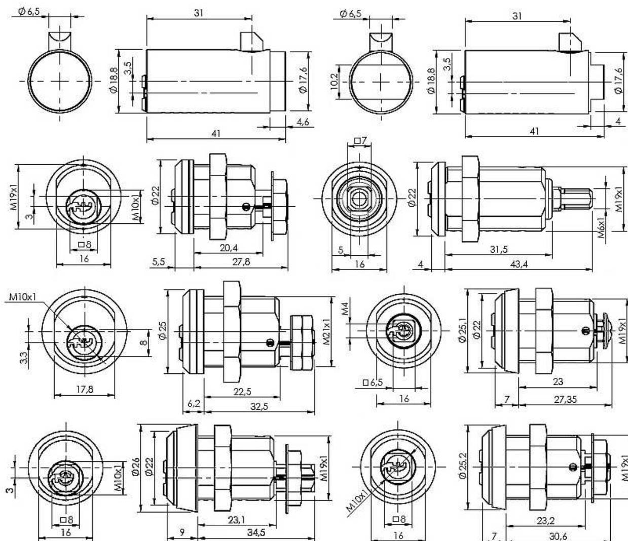
Les nombreux modèles de serrure de la gamme MINI8 permettent de verrouiller la plupart des Distributeurs Automatiques sur le marché.
